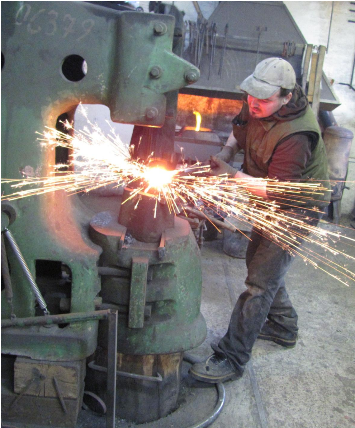
Tady pekne vidime odstrikujci oxidy zeleza.
